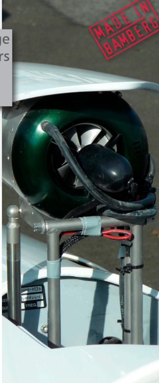
*Zu sehen ist ein Strahltriebwerk der Eichelsdörfer GmbH, mit dem Segelflugzeuge nachgerüstet werden sollen. Einige Prototypen sind bereits in den Lüften unterwegs.*
